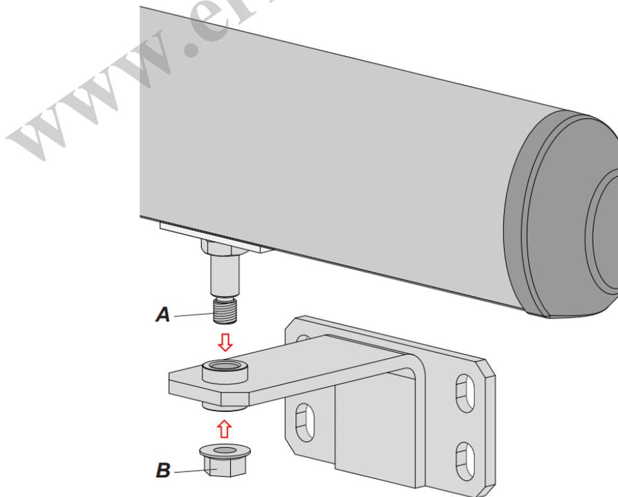
سپس جک را به کمک آچار مخصوص خلاص نمایید و شفت جک را به صورت کامل باز کنید.
